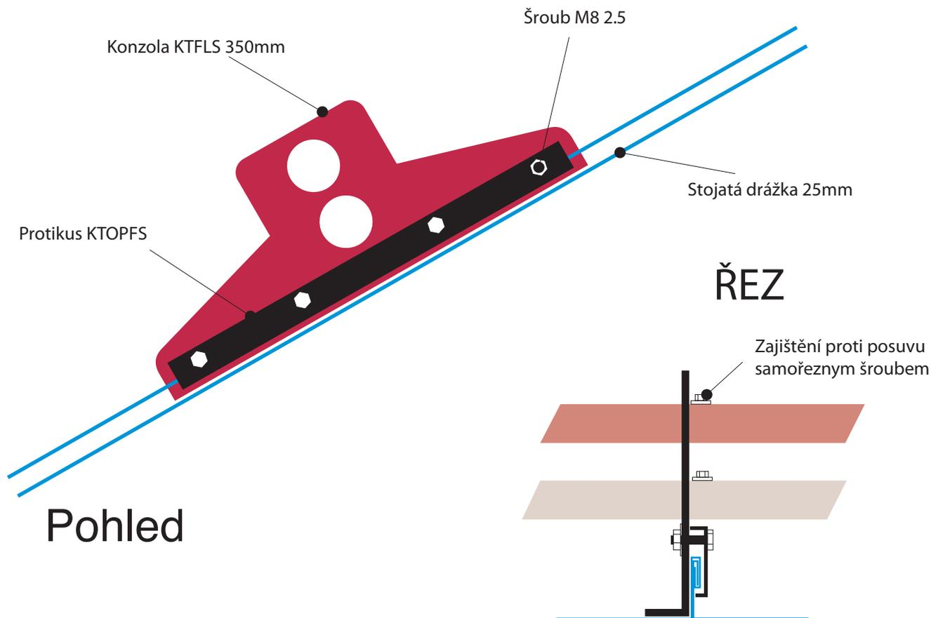
*Poznámka : Pro použití s protikusem na stojatou drážku se používá pouze konzola o délce 350mm*
